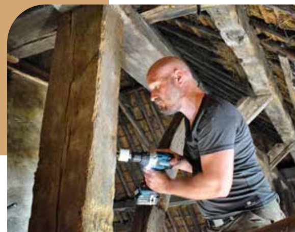
Monstername met een holle boor in een stolpboerderij in Oosterblokker. Het gaat hier om eikenhout uit het zuiden van Noorwegen. Het hout is gekapt in de herfst of winter van 1590/91.
